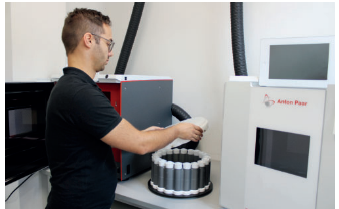
Neu im OELCHECK Labor – Zwei leistungsstarke Mikrowellengeräte Multiwave 5000 des Herstellers Anton Paar. Auf einem Rotorteller werden 20 Fettproben platziert. Für die Aufschließung der Proben benötigen die Mikrowellengeräte jeweils 90 Minuten zuzüglich 30 Minuten Abkühlzeit.
